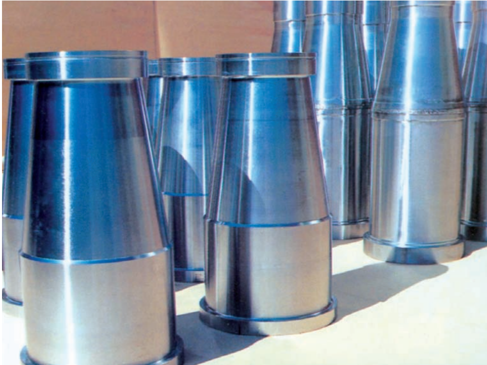
Trenntechnik: Dekanter-Mäntel – verschweißt aus horizontal und vertikal geschleuderten Teilen
